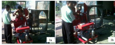
Gambar 3. Pengecekan mesin pencacah biomassa (3a). Pengencangan mur baut pada bodi dan cover mesin serta pada puli belt mesin pencacah biomassa (3b)
