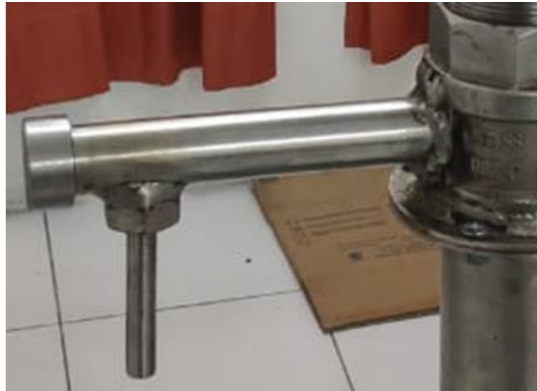
Gambar 9. Pipa pengarah selai ke dalam sachet dan botol
