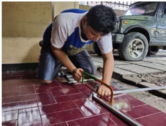
Gambar 5: Proses Pemotongan Bahan Aluminium Untuk Rangka Bilik Disinfektan
