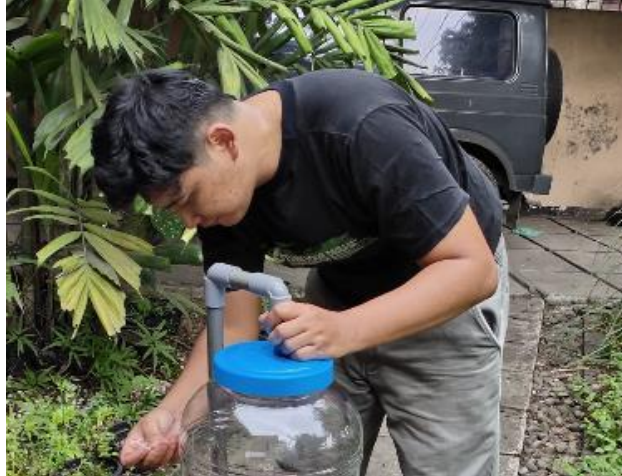
Gambar 10: Proses Pemasangan Pipa PVC Pada Tangki Cairan Disinfektan
