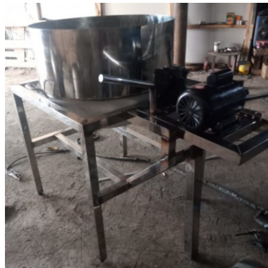
Gambar 3. Perakitan Rangka Utama
