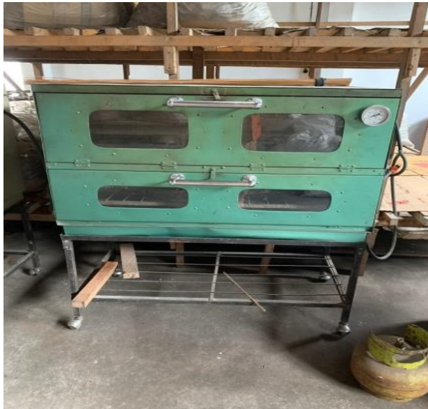
Gambar 8: Alat Pembakaran Kue Bagea Dengan Tenaga Listrik
