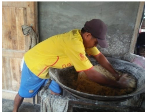
Gambar 2. Mengaduk adonan Roti Ketawa masih menggunakan tenaga manusia dengan kapasitas kerja 10 kg adonan sekali pengadukan dengan durasi 15 menit tiap sekali pengadukan.
