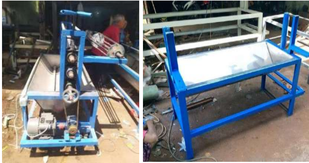
Gambar 3. Mesin Pelorot Malam
