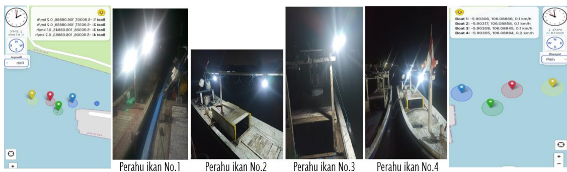
Gambar 10. Hasil pengujian komponen panel surya dan marine locator perahu ikan no.1, 2, 3, dan 4 pada waktu malam hari
