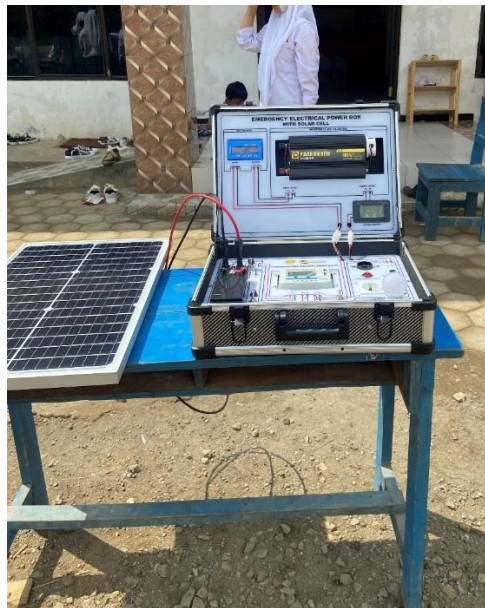
Gambar 6. Hasil Perancangan dan Perakitan Emergency Box
