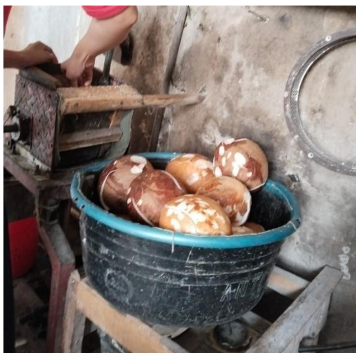
Gambar II. Parut mesin dan press santan
